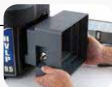
2 ProComp-Einheit in Spritzgerät einschieben
